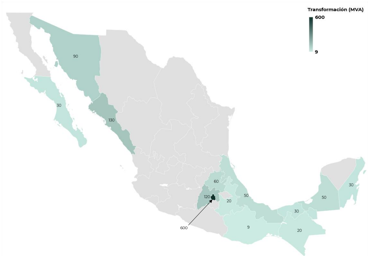
Figura 9.7.5. Capacidad (MVA) de Bancos de Transformación de las RGD del MEM legados por año de entrada en operación y nivel de tensión
