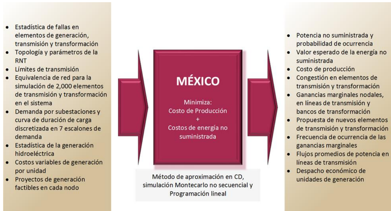
Figura 3.1.4. Proceso de estudios probabilísticos de Confiabilidad compuesta para la ampliación de la RNT y las RGD del Mercado Eléctrico Mayorista
