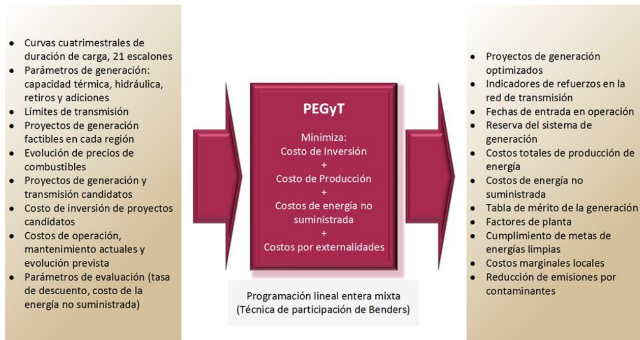
Figura 3.13. Proceso de estudios económicos y de energía de la ampliación de la RNT y las RGD del Mercado Eléctrico Mayorista
