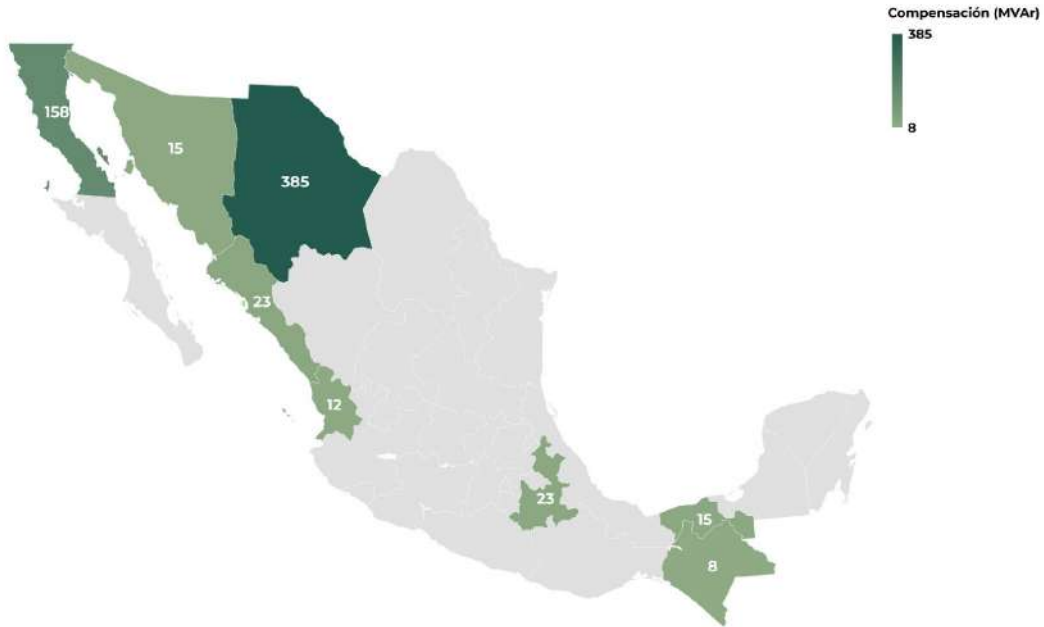
FIGURA 8.23 CAPACIDAD DE COMPENSACIÓN DE POTENCIA REACTIVA (MVAR) DE AMPLIACIÓN DE LA RNT IDENTIFICADOS POR ENTIDAD FEDERATIVA
