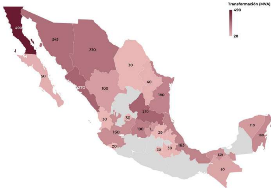
FIGURA 8.10 CAPACIDAD (MVA) DE BANCOS DE TRANSFORMACIÓN DE AMPLIACIÓN DE LAS RGD DEL MEM INSTRUIDOS POR SENER POR ENTIDAD FEDERATIVA
