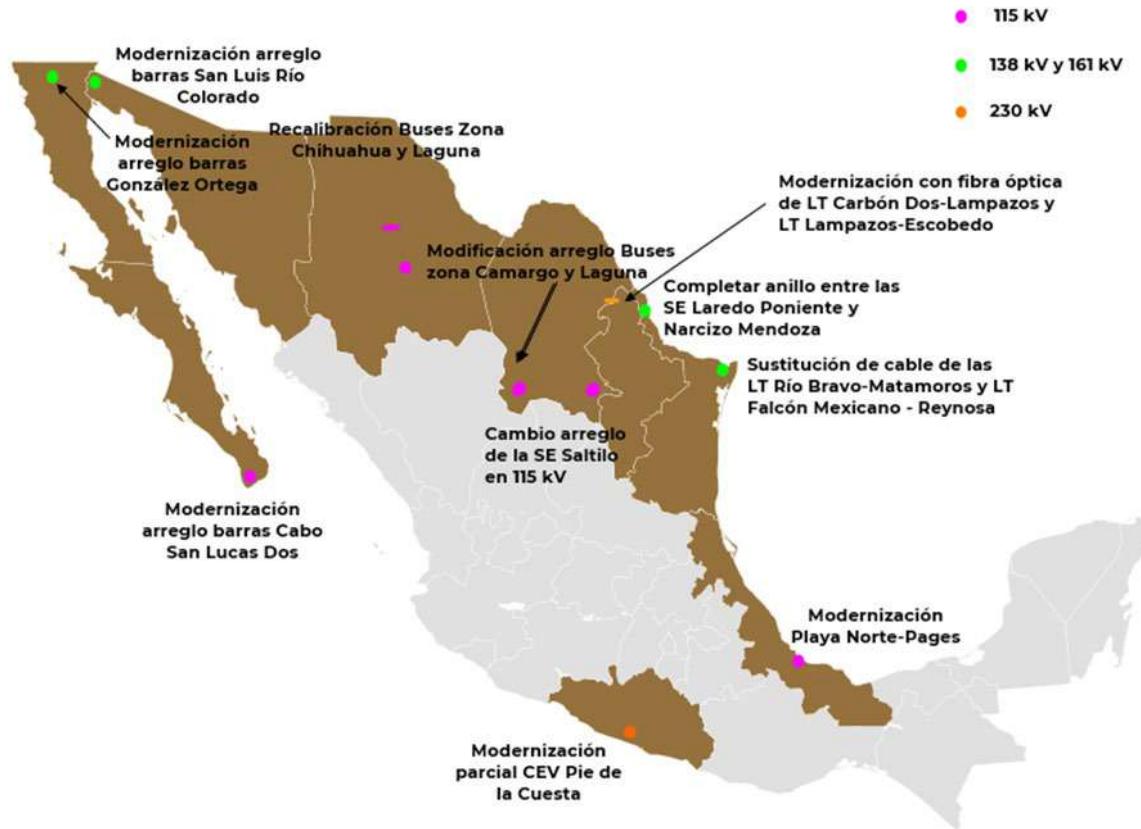
FIGURA 8.31 UBICACIÓN GEOGRÁFICA DE LOS PROYECTOS EN ESTUDIO DE MODERNIZACIÓN DE LA RNT PROPUESTOS POR CFE TRANSMISIÓN DEL PAMRNT 2022 - 2036
